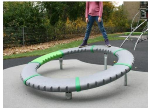
Для поддержки воспроизведения и подсчета оборотов при повороте один из сегментов кольца, либо один из соединительных кронштейнов, либо сегмент кольца окрашен в другой цвет.
