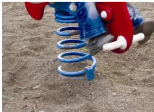
Пружины КОМПАΝ изготовлены из высококачественной пружинной стали в соответствии с EN10270. Пружины очищаются путем фосфатирования перед нанесением эпоксидной грунтовки и полиэфирного порошкового покрытия. Пружины фиксируются уникальными противозадирными фитингами для максимальной безопасности и длительного срока службы.
