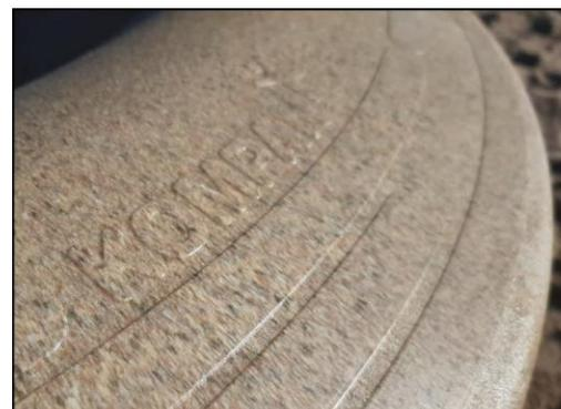
Вариант песочного цвета изготовлен из ротационного камня, смешанного с полиэтиленом с нескользящей текстурой поверхности. Возможны незначительные различия в визуальной структуре материала.
