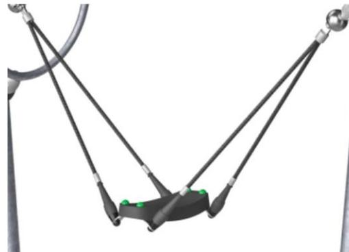
Веревки GALAXY состоят из шестицепочных стальных проволок и сердечника из стальной проволоки. Каждая прядь плотно обмотана нитью PES, которая расплавляется на каждую прядь. После того, как начальное трение убирает поверхностные волокна, остается более твердое покрытие из PES, защищая каждую прядь. Это придает канатам устойчивость к вандализму.
