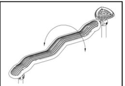
Информация по установке Макс. высота падения 51 cm Область безопасной 19,7 m<sup>2</sup> поверхности Кол-во установщиков Общее время установки 3.3 0,86 m3 Объем раскопок Объем бетона 0,48 m3 Глубина фундамента 90 cm 109 kg Вес груза Варианты крепления В грунт На поверхнос Оцинкованная сталь Пожизненная Компоненты PUR 10 лет Попые части РЕ 10 пет
