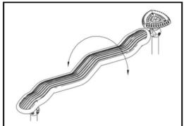
Раскачивание поддерживается стальной оцинкованной трубой диаметром 76х4 мм. Фиксация выполняется с помощью 5 уникальных нейлоновых (РА6) зажимов с ударопрочностью, которые позволяют качающейся трубе поворачиваться на 25 градусов вверх и вниз.
