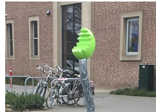
Цветной верх изготовлен из высококачественного нейлона (РА6), который стабилизирован ультрафиолетовым излучением для обеспечения длительного срока службы. Двухкомпонентная конструкция собрана со стальными штифтами вокруг стальной трубы.
