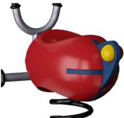
Сиденье изготовлено из переработанного полиэтилена и отлито в одно целое с минимальной толщиной стенки 5 мм. PE имеет высокую ударпрочность в широком диапазоне температур, что обеспечивает устойчивость к вандализму во всех местах.
