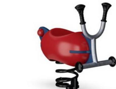
Пружины KOMPAN изготовлены из высококачественной пружинной стали в соответствии с EN10270. Пружины очищаются путем фосфатирования перед нанесением эпоксидной грунтовки и полиэфирного порошкового покрытия. Пружины фиксируются уникальными противозадирными фитингами для максимальной безопасности и длительного срока службы.
