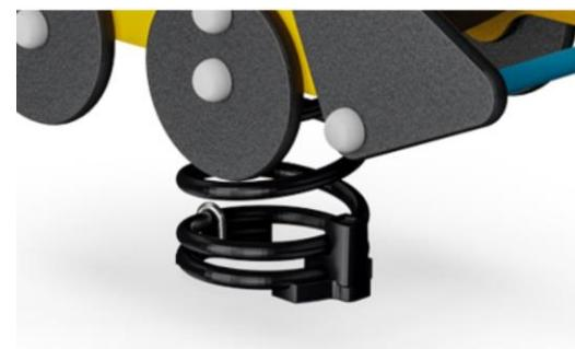
Пружины KOMPAN изготавлены из высококачественной пружинной стали в соответствии с EN10270. Пружины очищаются путем фосфатирования перед нанесением эпоксидной грунтовки и полиэфирного порошкового покрытия. Пружины фиксируются уникальными противозадирными фитингами для максимальной безопасности и длительного срока службы.
