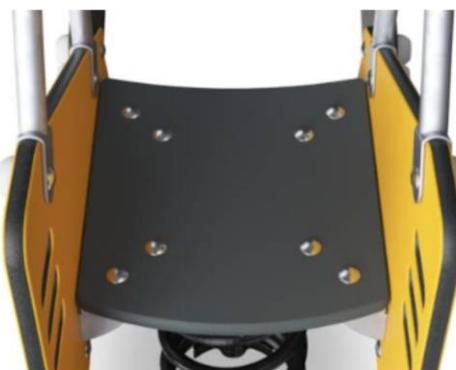
Сиденье изготовлено из панели Ekogrip®, которая состоит из полиэтиленовой основы толщиной 15 мм с верхним слоем из мягкой резины толщиной 3 мм с противоскользящим эффектом.
