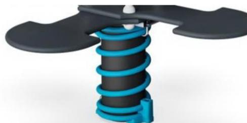
Пружины KOMPAN изготовлены из высококачественной пружинной стали в соответствии с EN10270. Пружины очищаются путем фосфатирования перед нанесением эпоксидной грунтовки и полиэфирного порошкового покрытия. Пружины фиксируются уникальными противозадирными фитингами для максимальной безопасности и длительного срока службы.
