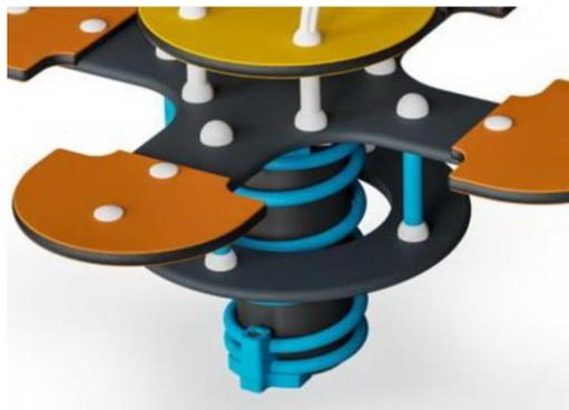
Пружины KOMPAN изготовлены из высококачественной пружинной стали в соответствии с EN10270. Пружины очищаются путем фосфатирования перед нанесением эпоксидной грунтовки и полиэфирного порошкового покрытия. Пружины фиксируются уникальными противозадирными фитингами для максимальной безопасности и длительного срока службы.
