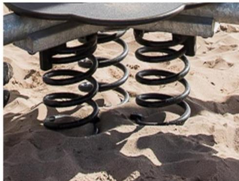
Пружины КОМПАН изготовлены из высококачественной пружинной стали в соответствии с EN10270. Пружины очищаются путем фосфатирования перед нанесением эпоксидной грунтовки и полиэфирного порошкового покрытия. Пружины фиксируются уникальными противозадирными фитингами для максимальной безопасности и длительного срока службы.
