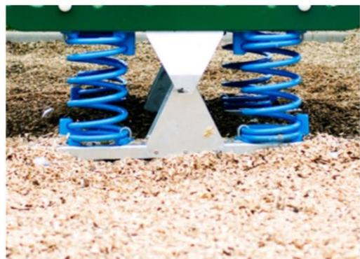
Пружины КОМПАН изготовлены из высококачественной пружинной стали в соответствии с EN10270. Пружины очищаются путем фосфатирования перед нанесением эпоксидной грунтовки и полиэфирного порошкового покрытия. Пружины фиксируются уникальными противозадирными фитингами для максимальной безопасности и длительного срока службы.
