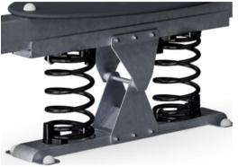
Пружины KOMPAN изготовлены из высококачественной пружинной стали в соответствии с EN10270. Пружины очищаются путем фосфатирования перед нанесением эпоксидной грунтовки и полиэфирного порошкового покрытия. Пружины фиксируются уникальными противозадирными фитингами для максимальной безопасности и длительного
