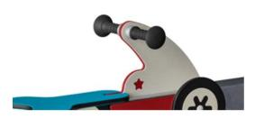
Две угловые верхние ручки изготовлены из литого полипропилена с наружным мягким слоем из резины TPV. Рукоятка прикреплена к трубе с помощью вставки из оцинкованной стали для обеспечения прочности и долговечности.
