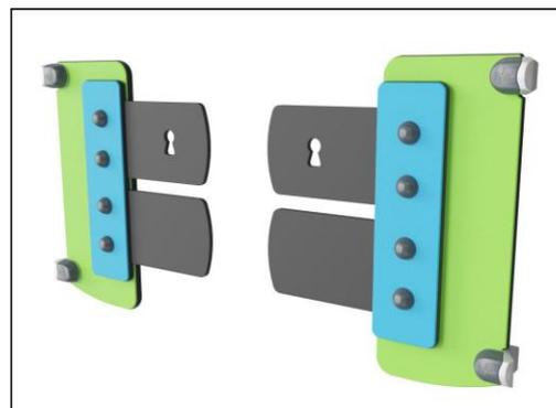
Мембраны состоят из износостойкого прорезиненного материала конвейерного качества с отличной стойкостью к ультрафиолетовому излучению. Закладка представляет собой четырехслойную броню из тканого полиэстера. В результате армирования и двух поверхностных слоев общая толщина составляет 9 мм.
