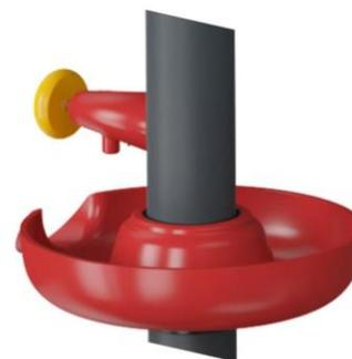
Встроенный водопроводный кран открывается при нажатии и останавливается при отпускании. Вода подается по трубе, расположенной внутри столба, при помощи шланга или трубного соединения в нижней части столба. Подача воды может быть осуществлена либо незакрепленным шлангом, либо канала, зарытого в землю.
