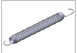
Все 52 пружин изготовлены из нержавеющей стали для обеспечения долговечности и отличной коррозионной стойкости. Толщина стальной проволоки составляет 3,2 мм, а последние пять витков имеют коническую форму, что обеспечивает долгий срок службы.
