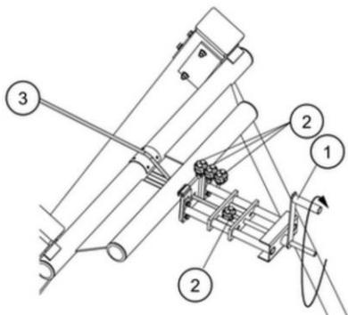
Стальной трос (3) натягивается с помощью специального устройства. Поворачивая ручку (1), можно безопасно натянуть стальной трос в соответствии с инструкцией. После натяжения трос фиксируется тремя зажимами (2). Натяжное устройство также можно использовать для регулировки во время ежегодных проверок.
