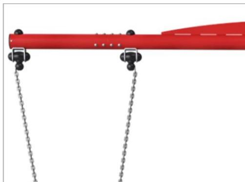
Подвески для сидений изготовлены из высококачественного нейлонового (PA6) корпуса с УФ-стабилизацией и встроенными герметичными шариковыми подшипниками. Цепи крепятся с помощью крюка из нержавеющей стали с защитными от кражи болтами «змеиный глаз» в поворотном корпусе, предотвращающем от закручивания.
