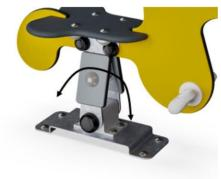
Раскачивающее движение по оси осуществляется мощным торсионным пружинным элементом ROSTA. Элемент ROSTA работает без шума и требует низких эксплуатационных расходов.
