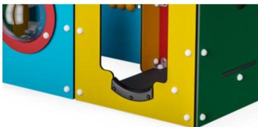
Защита для краев выполнена из полиуретана. Он сохраняет свои свойства в диапазоне температур от -30 ° C до 60 ° C. Материал стабилизирован ультрафиолетом.
