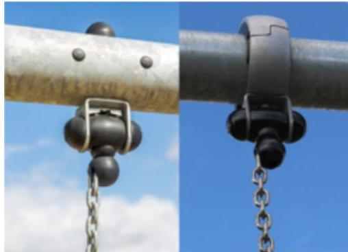
Подвески для качелей изготовлены из высококачественного нейлонового (PA6) корпуса с УФ-стабилизацией и встроенными герметичными шариковыми подшипниками. Регулируемые по высоте цепи фиксируются крюком из нержавеющей стали с защищенными от кражи болтами «змеиный глаз» в поворотном корпусе с защитой от скручивания. Все сиденья с фиксацией двух цепей доступны со стандартной подвеской или подвеской с функцией анти-закручивания.
