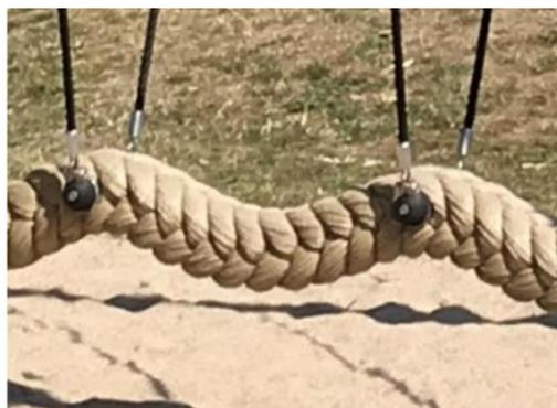
Веревка у качелей-маятника изготовлена из полипропиленовой (ПП) веревки в стиле кокоса квадратной формы 14x14см. Концы кокосовой веревки закрыты стальными зажимами и уплотнены приклеенной термоусадочной трубкой. Последние 10 см концов каната обрезаны, чтобы создать кисточку с функцией бампера для соответствия глобальным требованиям безопасности.
