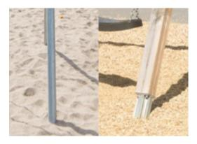
Опора качелей А-образной рамы доступна для закрепления на поверхности с помощью дюбелей или заглубления на глубине 60 или 90 см. Стальные опоры из оцинкованной стали закреплены непосредственно в земле. Столбы из сосны подняты над землей уникальным профилированным основанием из оцинкованной стали.
