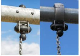
Подвески для качелей изготовлены из высококачественного нейлонового (РА6) корпуса с УФ-стабилизацией и встроенными герметичными шариковыми подшипниками. Регулируемые по высоте цепи фиксируются крюком из нержавеющей стали с защищенными от кражиболтами «змеиный глаз» в поворотном корпусе с защитой от скручивания. Все сиденья с фиксацией двух цепей доступны со стандартной подвеской или подвеской с функцией антизакручивания.
