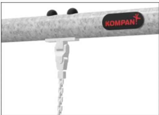
Разработанные KOMPAN подвески для качелей из нержавеющей стали с функцией анти-закручивание. Подвески крепятся к поперечной балке на сварном кронштейне с помощью двух болтов. Подшипники залиты силиконовой смазкой и не требуют дополнительной смазки.
