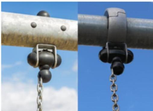
Подвески для качелей изготовлены из высококачественного нейлонового (РА6) корпуса с УФ-стабилизацией и встроенными герметичными шариковыми подшипниками. Регулируемые по высоте цепи фиксируются крюком из нержавеющей стали с защищенными от кражи болтами «змеинный глаз» в поворотном корпусе с защитой от скручивания. Все сиденья с фиксацией двух цепей доступны со стандартной подвеской или подвеской с функцией анти-закручивания.
