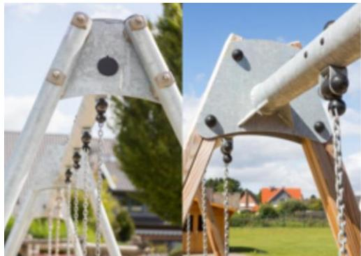
А-образная рама оснащена ригелем горячего цинкования диаметром 100 мм с крупными стальными концевыми пластинами для прочной фиксации двух опор: сталь горячего цинкования диаметром 70 мм. Пропитанная древесина сосны с опорами из оцинкованной стали.
