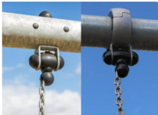
Подвески для качелей изготовлены из высококачественного нейлонового (РА6) корпуса с УФ-стабилизацией и встроенными герметичными шариковыми подшипниками. Регулируемые по высоте цепи фиксируются крюком из нержавеющей стали с защищенными от кражи болтами «змеиный глаз» в поворотном корпусе с защитой от скручивания. Все сиденья с фиксацией двух цепей доступны со стандартной подвеской или подвеской с функцией анти-закручивания.
