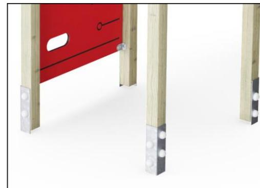
Основные столбы оснащены стальными опорами из оцинкованной стали. Стальные опоры поднимают столбы на 20 мм над уровнем земли, чтобы избежать контакта с наплавочным материалом.
