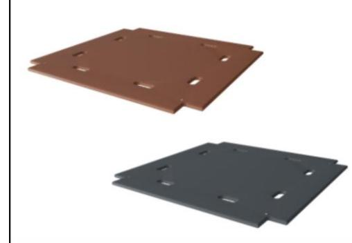
Полы и панели доступны из двух материалов: водостойкие фанерные настилы толщиной 21,5 мм из сосны и ольхи с противоскользящей пленкой с обеих сторон и ламинат высокого давления HPL толщиной 17,8 мм с нескользящей текстурой поверхности в соответствии с EN 438-6.
