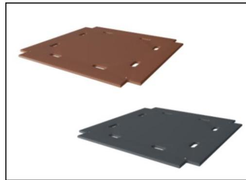
Полы и панели доступны из двух материалов: водостойкие фанерные настилы толщиной 21,5 мм из сосны и ольхи с противоскользящей пленкой с обеих сторон и ламинат высокого давления HPL толщиной 17,8 мм с нескользящей текстурой поверхности в соответствии с EN 438-6.
