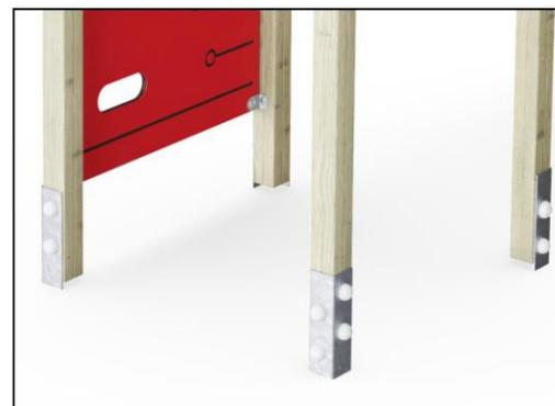
Основные столбы оснащены стальными опорами из оцинкованной стали. Стальные опоры поднимают столбы на 20 мм над уровнем земли, чтобы избежать контакта с наплавочным материалом.
