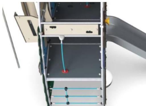
Все полы изготовлены из ламината высокого давления HPL толщиной 17,8 мм и с нескользящей текстурой поверхности в соответствии с EN 438-6. KOMPAN HPL обладает высокой износостойкостью, что обеспечивает длительный срок службы в любых климатических условиях.
