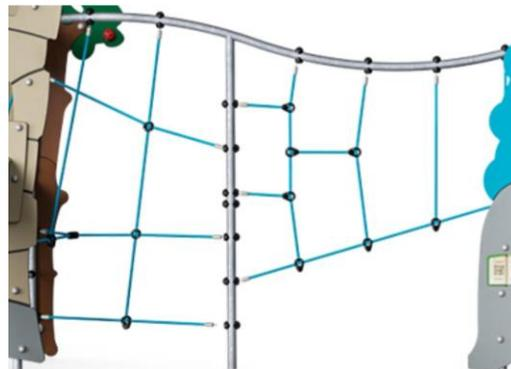
Канаты изготовлены из УФ-стабилизированного полиамида с внутренним усилением стального троса. Канат подвергается индукционной обработке для создания прочного соединения между сталью и веревкой, что обеспечивает хорошую износостойкость.
