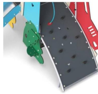
Изогнутая стена для лазанья изготовлена из панели Ekogrip, которая состоит из полиэтиленовой основы толщиной 15 мм с верхним слоем из мягкой резины толщиной 3 мм с противоскользящим эффектом.
