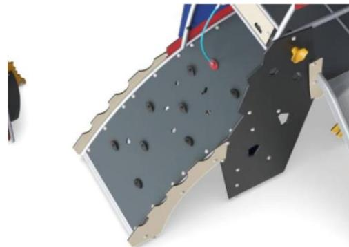
Изогнутая стена для лазанья изготовлена из панели Ekogrip, которая состоит из полиэтиленовой основы толщиной 15 мм с верхним слоем из мягкой резины толщиной 3 мм с противоскользящим эффектом.
