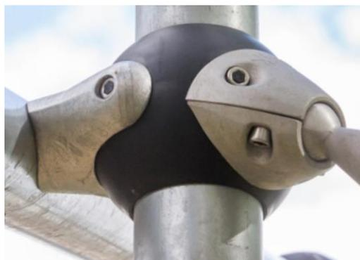
Соединительный шар GALAXY уникальной конструкции выполнен с внутренним круглым алюминиевым сердечником, окруженным оболочкой из твердого полипропилена с наружным слоем из мягкой резины TPV. Гибкие бесвинцовые алюминиевые соединители позволяют устанавливать их под разными углами.
