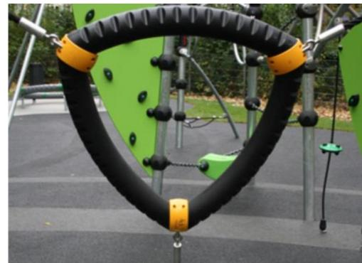
Альпийские треугольники серии Galaxy с наружным мягким слоем из полиуретана и угловые кронштейны из литого нейлона (РА6). Сердцевина состоит из сварной стальной рамы с порошковым покрытием и встроенными угловыми точками подвески. Большие треугольники закрыты панелью Ekogrip® толщиной 18 мм с верхним слоем резины с противоскользящим эффектом.
