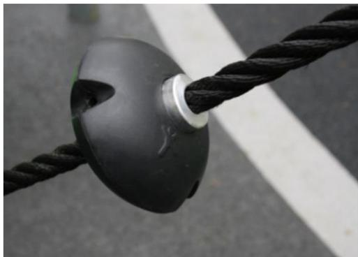
Веревки GALAXY состоят из шестицепочных стальных проволок и сердечника из стальной проволоки. Каждая прядь плотно обмотана нитью PES, которая расплавляется на каждую прядь. После того, как начальное трение убирает поверхностные волокна, остается более твердое покрытие из PES, защищая каждую прядь. Это придает канатам устойчивость к вандализму.
