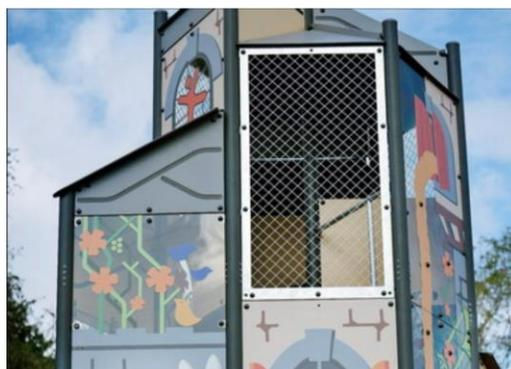
Полностью сварная стальная рама с 45" поперечной сварной стальной сеткой из круглых стальных штифтов диаметром 4мм. Панель воздушного потока способствует общей структурной целостности башен Гигантов.
