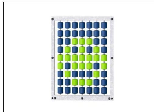
Два цветных поворотных ролика изготовлены из высококачественного УФ-стабилизированного и усиленного нейлона (РА). Ролики собраны на вертикальных стальных трубах в сварной раме. Все стальные детали оцинкованы горячим способом.
