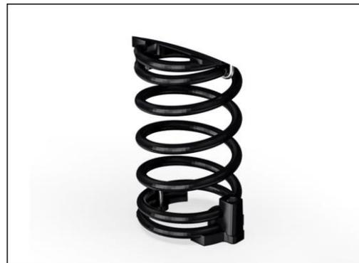
Пружины KOMPAN изготовлены из высококачественной пружинной стали в соответствии с EN10270. Пружины очищаются путем фосфатирования перед нанесением эпоксидной грунтовки и полиэфирного порошкового покрытия. Пружины фиксируются уникальными противозадирными фитингами для максимальной безопасности и длительного срока службы.
