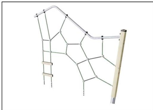
Канатные сети изготовлены из одинарных плетеных канатов из ПЭЭС диаметром 16 мм. PES обладает высокой прочностью и отличной устойчивостью к истиранию и УФ-излучению. Тросовые петли собраны с помощью алюминиевых соединителей.
