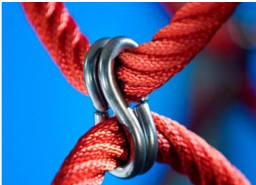
Зажимы Corocord 'S' используются в качестве универсальных соединений в изделиях Corocord. 8-миллиметровые стержни из нержавеющей стали с закругленными краями прижимаются к канатам на каждую специальную гидравлического пресса, что делает их идеальным соединителем: безопасным, долговечным и защищенным от вандализма, и в то же время допускающим обычное движение игровых канатных конструкций.
