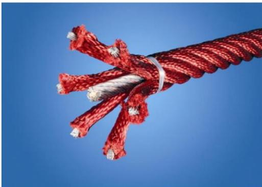
Веревки Corocord диаметром 19 мм и более - это особый тип «Геркулес» с оцинкованными шестистручными стальными проволоками. Каждая нить плотно обмотана нитью PES, которая расплавляется на каждую индивидуальную прядь. Веревки обладают высокой стойкостью к износу и устойчивостью к вандализму. При необходимости могут быть заменены на месте.
