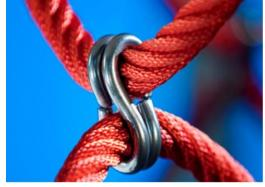
Зажимы Corocord 'S' используются в качестве универсальных соединений в изделиях Corocord. 8-миллиметровые стержни из нержавеющей стали с закругленными краями прижимаются к канатам с помощью специального гидравлического пресса, что делает их идеальным соединителем: безопасным, долговечным и защищенным от вандализма, и в то же время допускающим
