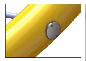
Трос крепится к большой стальной трубе с помощью уникального затяжного решения КОМРАN. Он состоит из внутренней и внешней нейлоновых (РА6) втулок, которые направляют трос к алюминиевой детали с внешней резьбой, которая натягивает трос.
