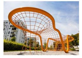
Стальная поверхность этих гнутых стальных труб окрашивается в мокром состоянии одним основным слоем и одним верхним слоем бесцветного свинцового материала. Краска обладает отличной коррозионной стойкостью и легко поддается уходу.
