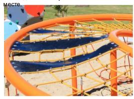
Мембраны Corocord состоят из износостойкого прорезиненного материала конвейерного качества с отличной стойкостью к ультрафиолетовому излучению. Протестировано и соответствует требованиям REACH для ЛАГ. Закладка представляет собой четырехслойную броню из тканого полиэстера. В результате армирования и двух поверхностных слоев общая долщина составляет 7,5 мм.
