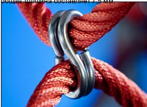
Зажимы Corocord 'S' используются в качестве универсальных соединений в изделиях Corocord. 8-миллиметровые стержни из нержавеющей стали с закругленными краями прижимаются к канатам с помощью специального гидравлического пресса, что делает их идеальным соединителем: безопасным, долговечным и защищенным от вандализма, и в то же время допускающим обычное движение игровых канатных конструкций.
