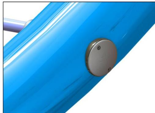
Трос крепится к большой стальной трубе с помощью уникального затяжного решения KOMPAN. Он состоит из внутренней и внешней нейлоновых (PA6) втулок, которые направляют трос к алюминиевой детали с внешней резьбой, которая натягивает трос.
