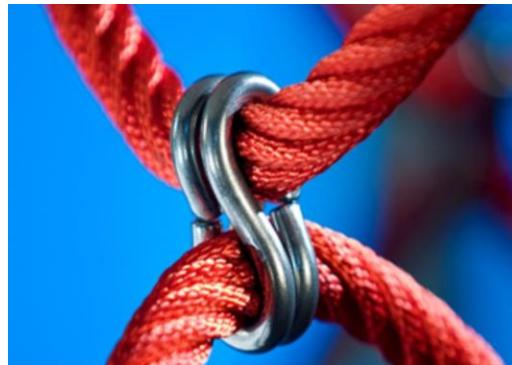
Зажимы Corocord 'S' используются в качестве универсальных соединений в изделиях Corocord. 8-миллиметровые стержни из нержавеющей стали с закругленными краями прижимаются к канатам с помощью специального гидравлического пресса, что делает их идеальным соединителем: безопасным, долговечным и защищенным от вандализма, и в то же время допускающим обычное движение игровых канатных конструкций.
