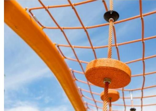
Полностью окрашенные резиновые диски EPDM с гладкой поверхностью. Формованный EPDM окружает стальной сердечник из горяче оцинкованной стали, который обеспечивает как стабильность дисков, так и долговечную фиксацию на канате.
