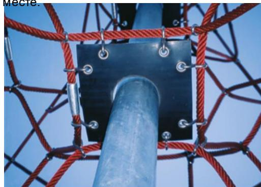
Мембранны Corocord состоят из износостойкого прорезиненного материала конвейерного качества с отличной стойкостью к ультрафиолетовому излучению. Протестировано и соответствует требованиям REACH для ЛАГ. Закладка представляет собой четырехслойную броню из тканого полиэстера. В результате армирования и двух поверхностных слоев общая толщина составляет 7,5 мм.
