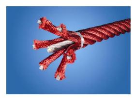
Веревки Corocord диаметром 19 мм и более это особый тип «Геркулес» с оцинкованными шестистрочными стальными проволоками. Каждая нить плотно обмотана нитью PES, которая расплавляется на каждую индивидуальную прядь. Веревки обладают высокой стойкостью к износу и устойчивостью к вандализму. При необходимости могут быть заменены на
